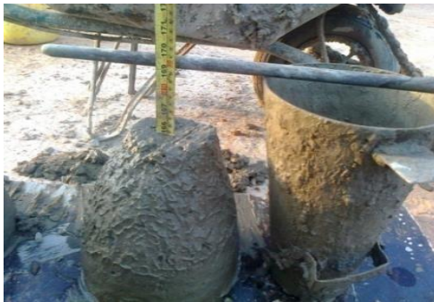
Fig.2. Slump Cone Test
